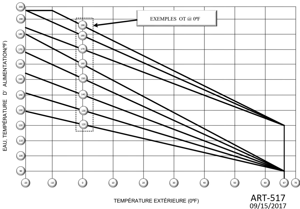
**OT @ 0 °F SP :** lorsque cette chaudière fonctionne en mode de régulation extérieure (sonde extérieure connectée), réglez cette valeur de consigne selon la température de caloporteur voulue lorsque la température extérieure est de 0 °F. À mesure que la température extérieure fluctue, la température de consigne varie pour tenter d'équilibrer la sortie de chaudière avec la demande de chaleur du bâtiment.
