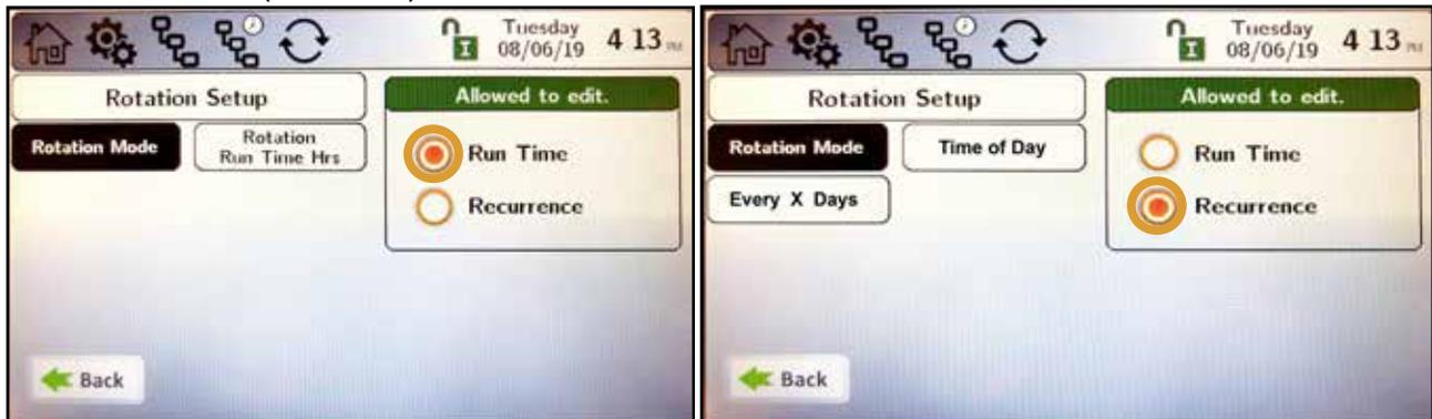
Seule la durée d'exécution de la rotation est réglable dans le mode **Durée de fonctionnement (Run Time)**. Cela permet de choisir l'appareil qui démarre en premier en fonction du nombre d'heures de fonctionnement.
