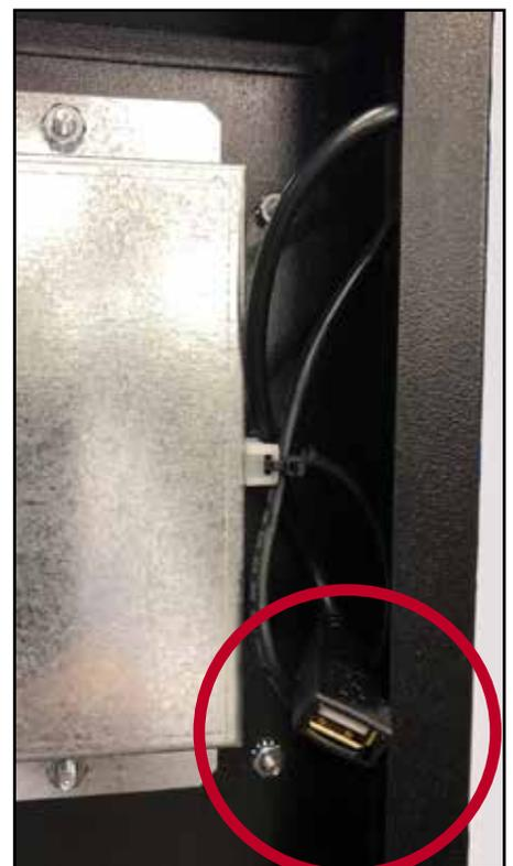
Figure 49. Photo de la prise USB placée à l'arrière de l'écran tactile.
