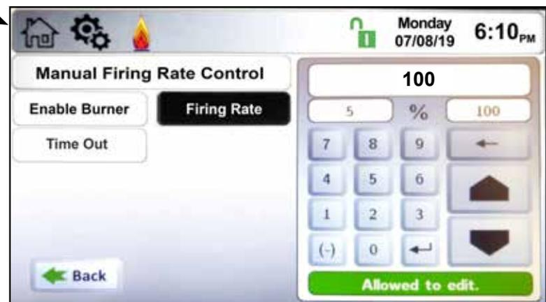
8. Au besoin, régler la vis de réglage de pression de combustible (voir figure 51) pour obtenir une valeur de **mesure de CO<sub>2</sub> à allure maximale de 9,0 % +/- 0,2 %.**
