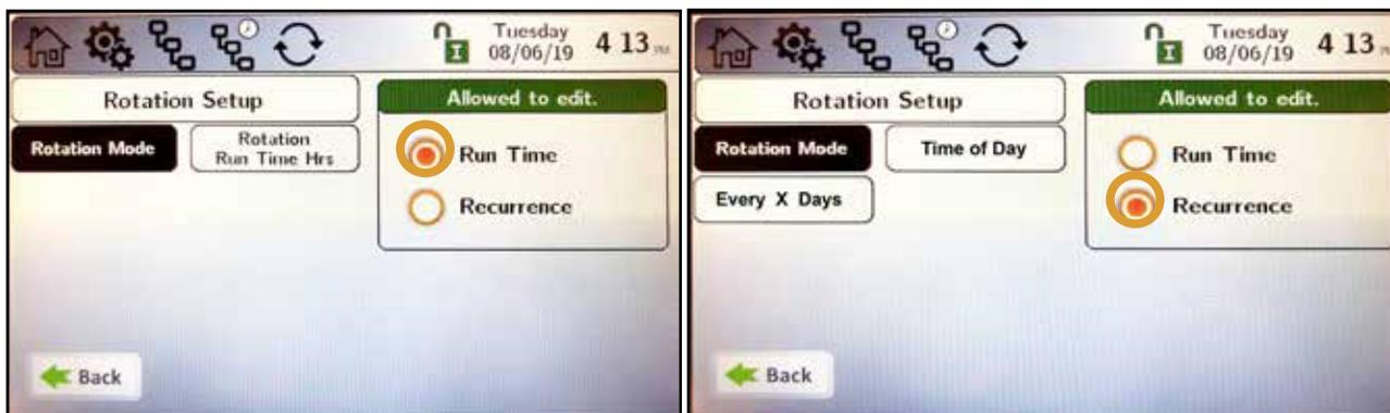
Seule la durée d'exécution de la rotation est réglable dans le mode **Durée de fonctionnement (Run Time)**. Cela permet de choisir l'appareil qui démarre en premier en fonction du nombre d'heures de fonctionnement.
