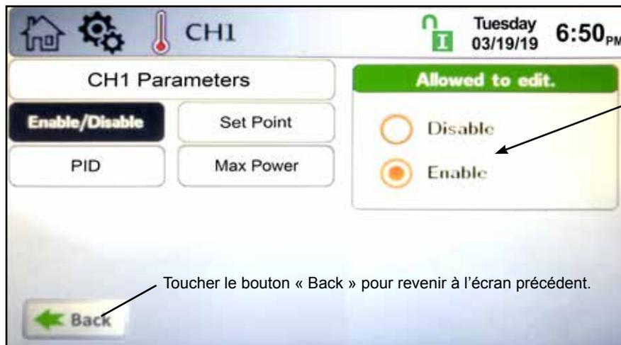
L'option sélectionnée est indiquée par la présence d'un point orange. Certains écrans ne vous offrent que deux options de réglage, tandis que d'autres (écran de sélection de la pompe, par exemple) vous permettent de sélectionner une ou plusieurs options, voire aucune.
