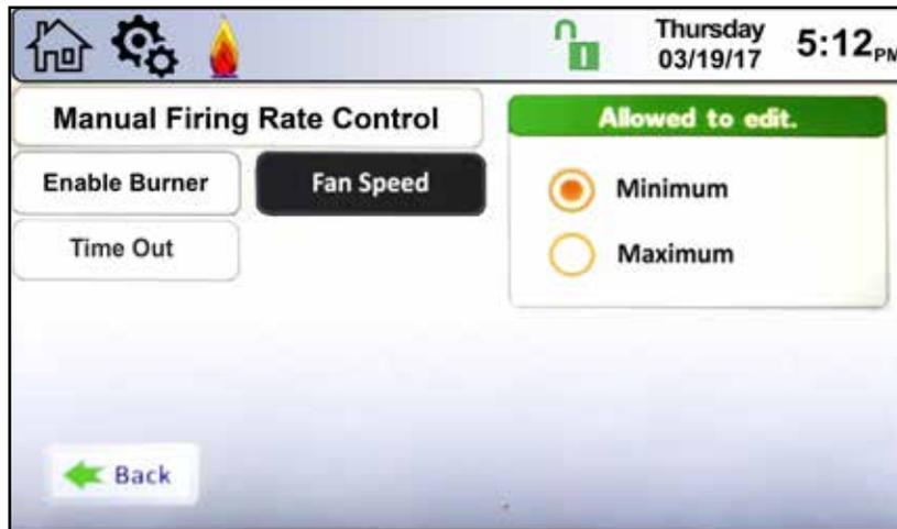
9. Laisser l'appareil se stabiliser à l'allure de chauffe minimale. Voir l'image ci-dessous. Observer le taux de CO<sub>2</sub> avec un analyseur de combustion et tourner la vis de réglage d'allure minimale placée sur la vanne de gaz principale pour obtenir la mesure de CO<sub>2</sub> à allure minimale indiquée dans le Tableaux 23. Consulter le fabricant si la valeur de CO<sub>2</sub> est supérieure à celle spécifiée dans le tableaux.
