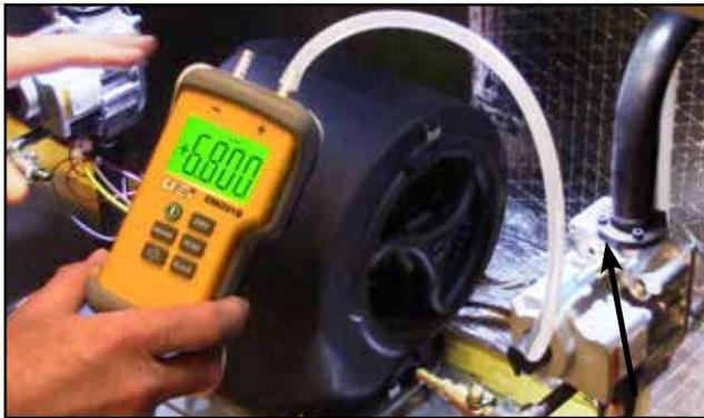
Figure 36. Mesure de la pression d'alimentation en gaz
