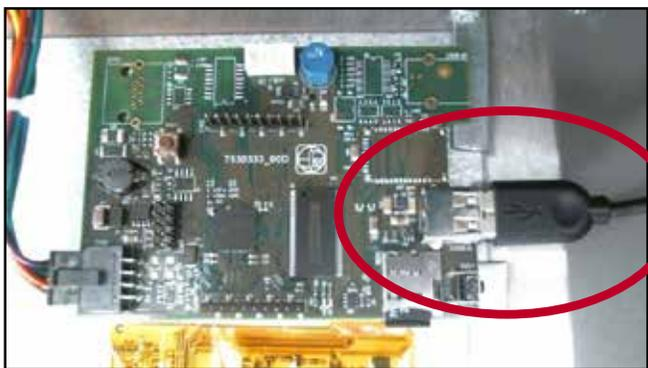
Figure 43. Photo de la prise USB placée à l'arrière de l'écran tactile.
