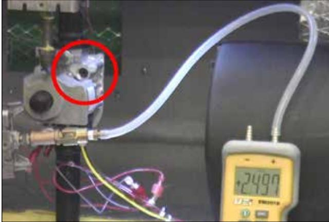
**Figure 40. Mesure/réglage de la pression au collecteur**
