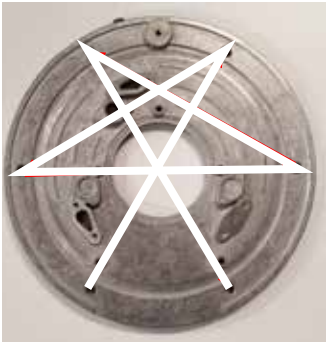
Figure 48. Serrage en étoile
