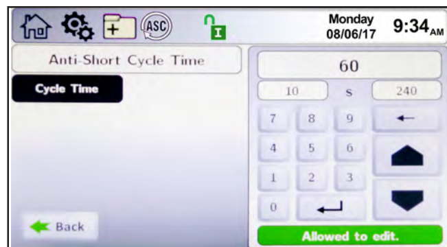
Écran 20. Écran de configuration du temporisateur contre cycle court
