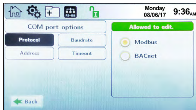
Écran 21. Écran de configuration du port COM, Modbus
