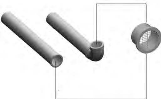
Figure 10. Crépines de ventilation de 3 po
