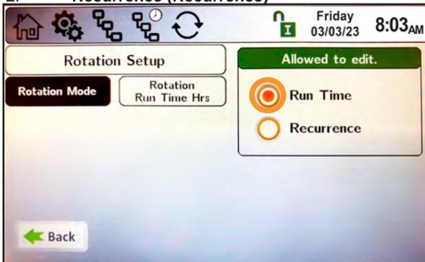
Seule la durée d'exécution de la rotation est réglable dans le mode **Durée de fonctionnement (Run Time)**. Cela permet de choisir l'appareil qui démarre en premier en fonction du nombre d'heures de fonctionnement.
