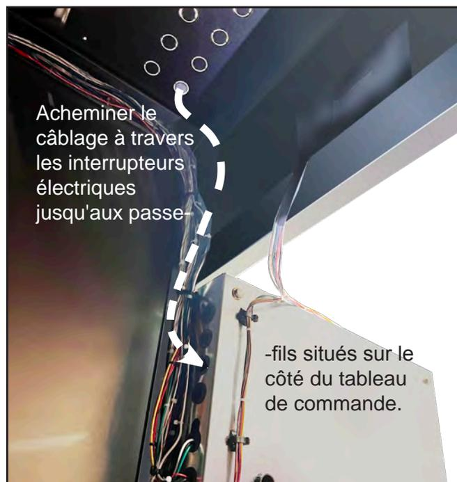
Figure 34. Branchements électriques
