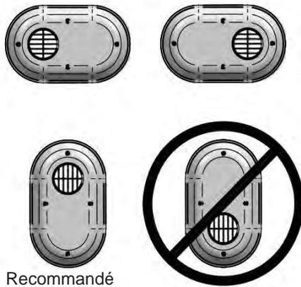
Figure 12. Orientations des terminaisons compactes
