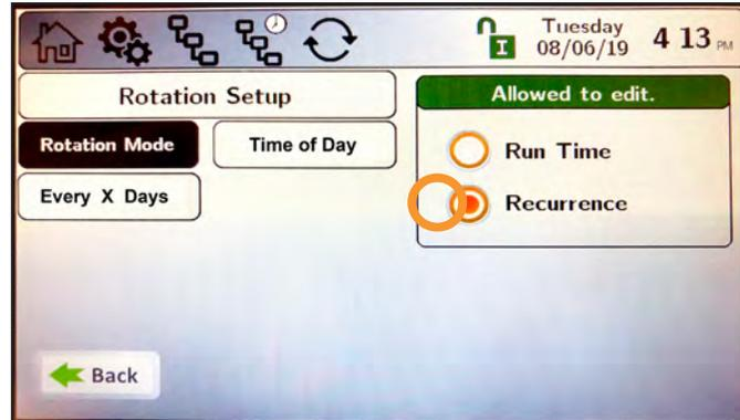
Seule la durée d'exécution de la rotation est réglable dans le mode **Durée de fonctionnement (Run Time)**. Cela permet de choisir l'appareil qui démarre en premier en fonction du nombre d'heures de fonctionnement.
