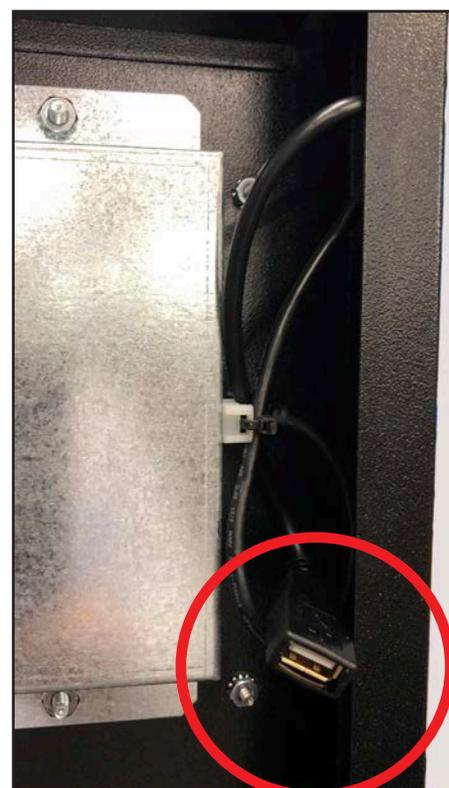
Figure 49. Photo de la prise USB à l'arrière de l'écran tactile.
