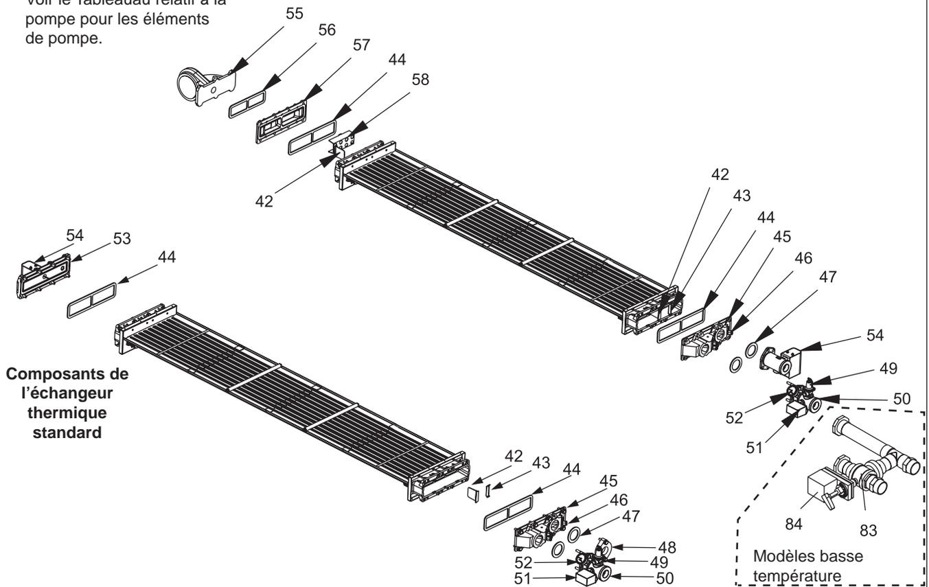
**Composants de l'échangeur thermique standard**
