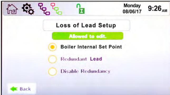
Écran 32. Écran de configuration de redondance de cascade (Loss of Lead Setup/perte de Lead)
