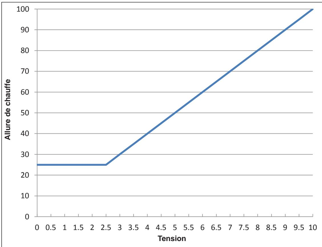
Figure 34. Contrôle de l'allure de chauffe
