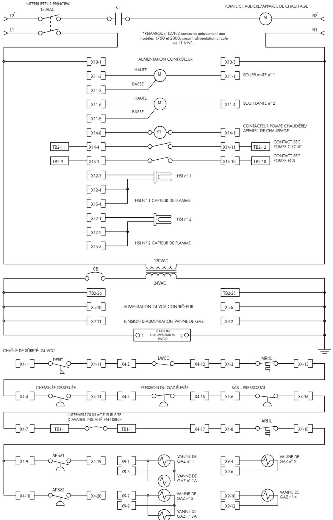
Figure 28. Schéma à relais Capacités 500 à 2000
