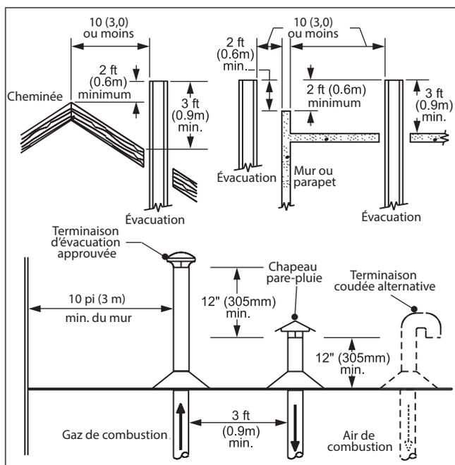
Figure 2. Air de combustion et évacuation des gaz de combustion par le toit
