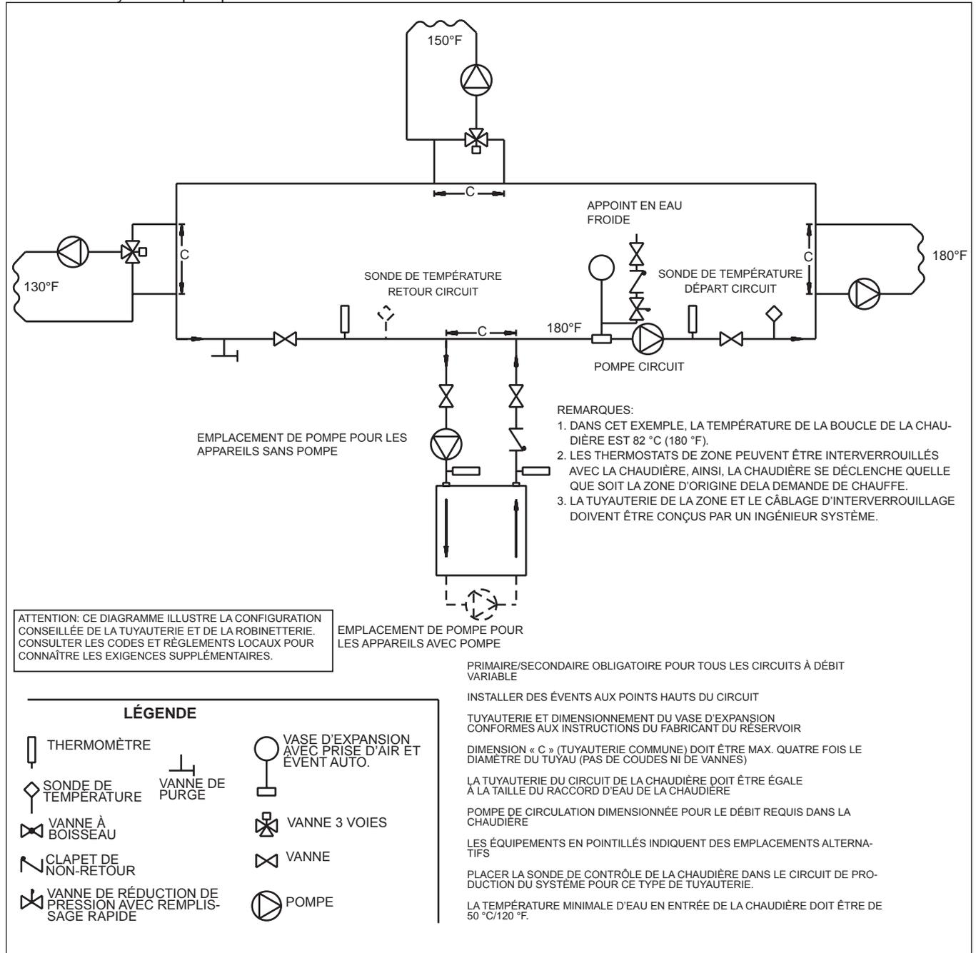
Figure 8. Tuyauterie hydronique – Une chaudière, circuits à température multiple.
