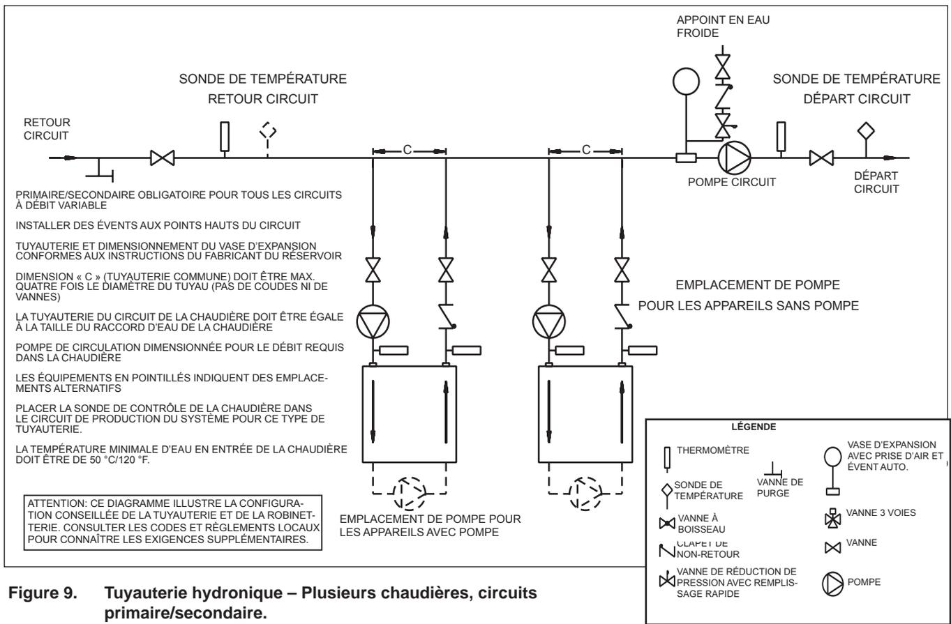
Figure 9. Tuyauterie hydronique – Plusieurs chaudières, circuits primaire/secondaire.
