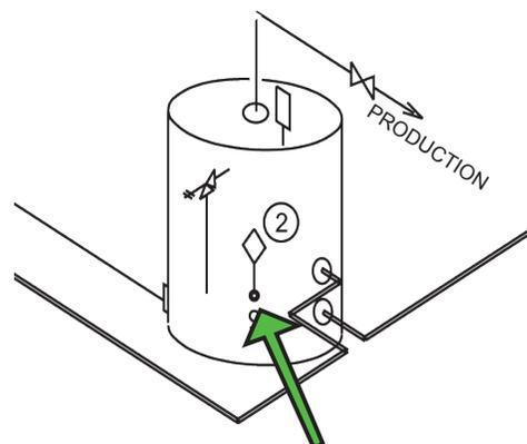
Figure 7. Emplacement de la sonde de réservoir ECS
