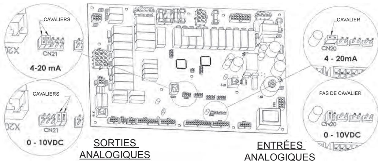
Figure 23. Position des cavaliers pour l'entrée et la sortie analogiques
