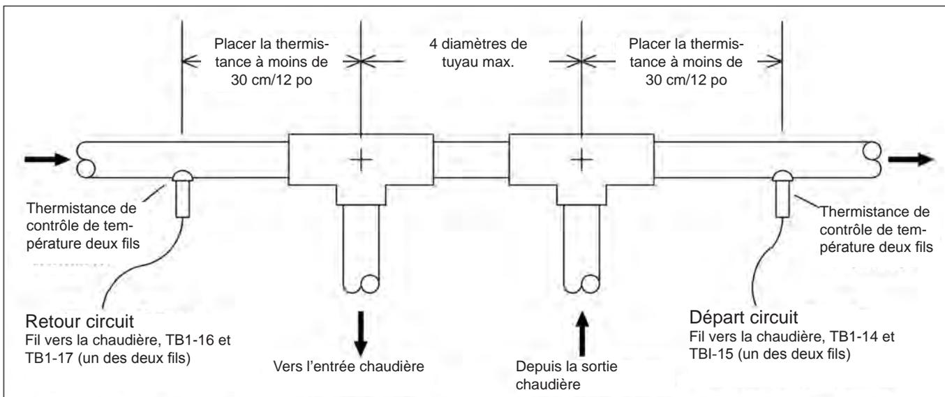
Figure 4. Tuyauterie de la chaudière basse température
