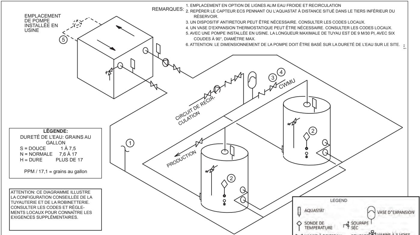
Figure 17. Tuyauterie du chauffe-eau – Un chauffe-eau, plusieurs réservoirs
