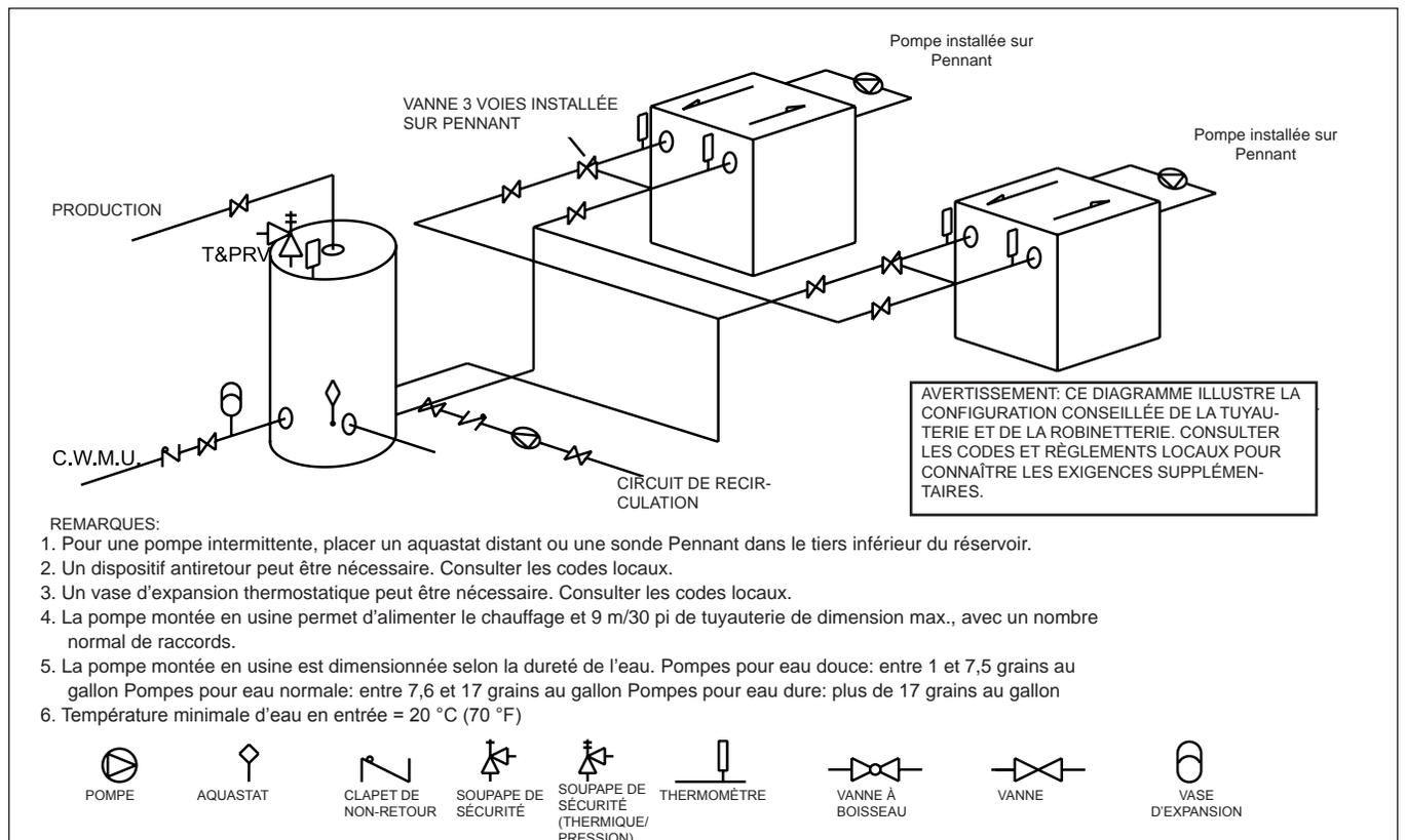
Figure 16. Suggestion de tuyauterie, système basse température — Plusieurs chauffe-eau, un réservoir
