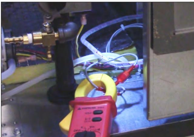
**Figure 42. Ampèremètre autour d'un fil de l'allumeur**
