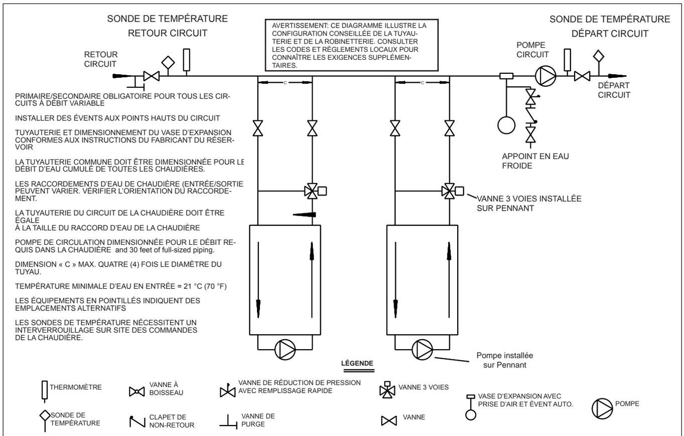
Figure 10. Basse température, circuit primaire/secondaire
