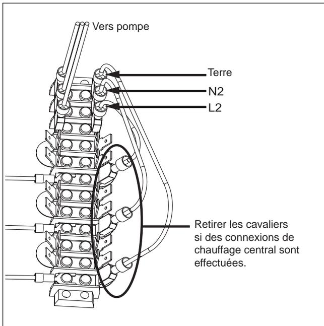
Figure 21. Retrait des cavaliers sur le bornier d'entrée
