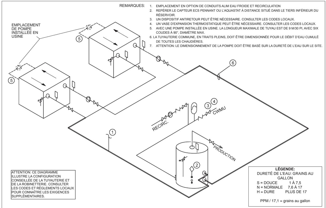
Figure 15. Tuyauterie du chauffe-eau – Plusieurs chauffe-eau, un réservoir
