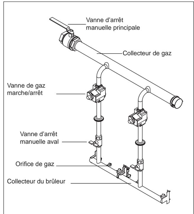
Figure 46. Configuration caractéristique du circuit de gaz
