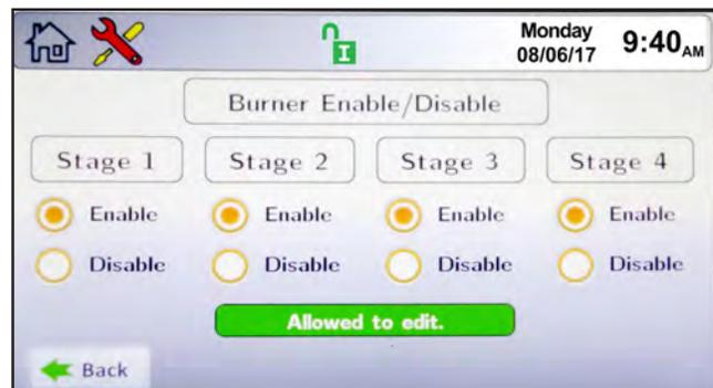
Figure 39. Écran Brûleur Activé/désactivé (Burner Enable/Disable)
