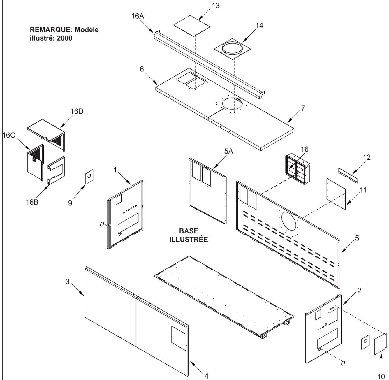
Figure 48. Composants en tôle
