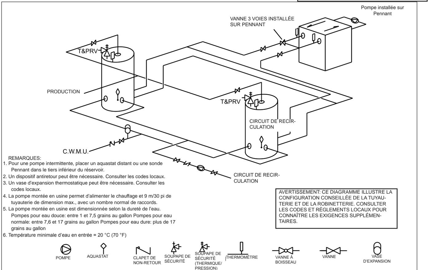
Figure 18. Suggestion de tuyauterie, système basse température — Un chauffe-eau, plusieurs réservoirs
