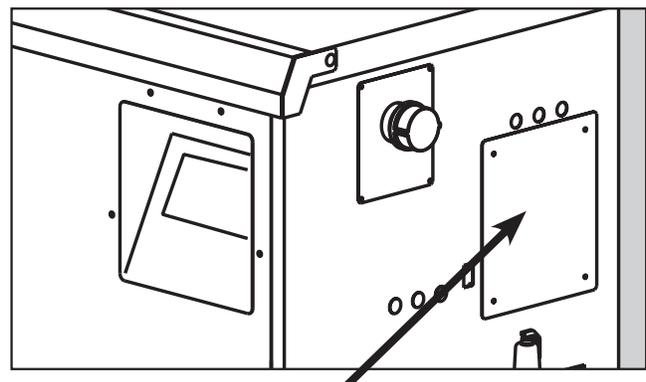
Figure 22. Panneau d'accès pour les connexions sur site
