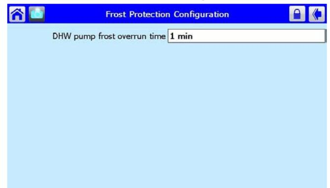
La protection contre le gel permet d'éviter que l'appareil ne gèle lorsqu'il ne s'allume pas, mais que les pompes fonctionnent. Sur cet écran, le paramètre de durée de dépassement de la protection contre le gel (frost overrun time) peut être modifié.
