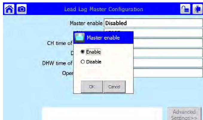
Sélectionner l'option Activer (Enable) du contrôleur principal et appuyer sur OK.
