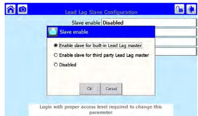
Sélectionner Activer le suisvant pour le principal intégré (Enable Follower for built-in Lead Lag Leader). Appuyer ensuite sur « OK »
