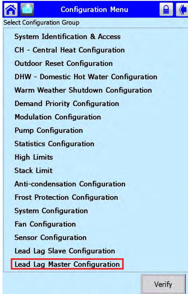
Dans ce menu de configuration, faire défiler vers le bas et appuyer sur Configuration en cascade – principal (Lead Lag Master Configuration).
