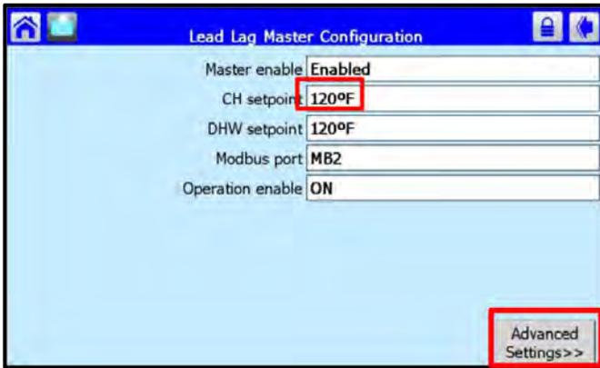
Une fois le contrôleur principal activé (Enable), appuyez le champ du Point de consigne CH (CH Setpoint). Ce champ permet de régler la température de consigne globale du système en cascade.
