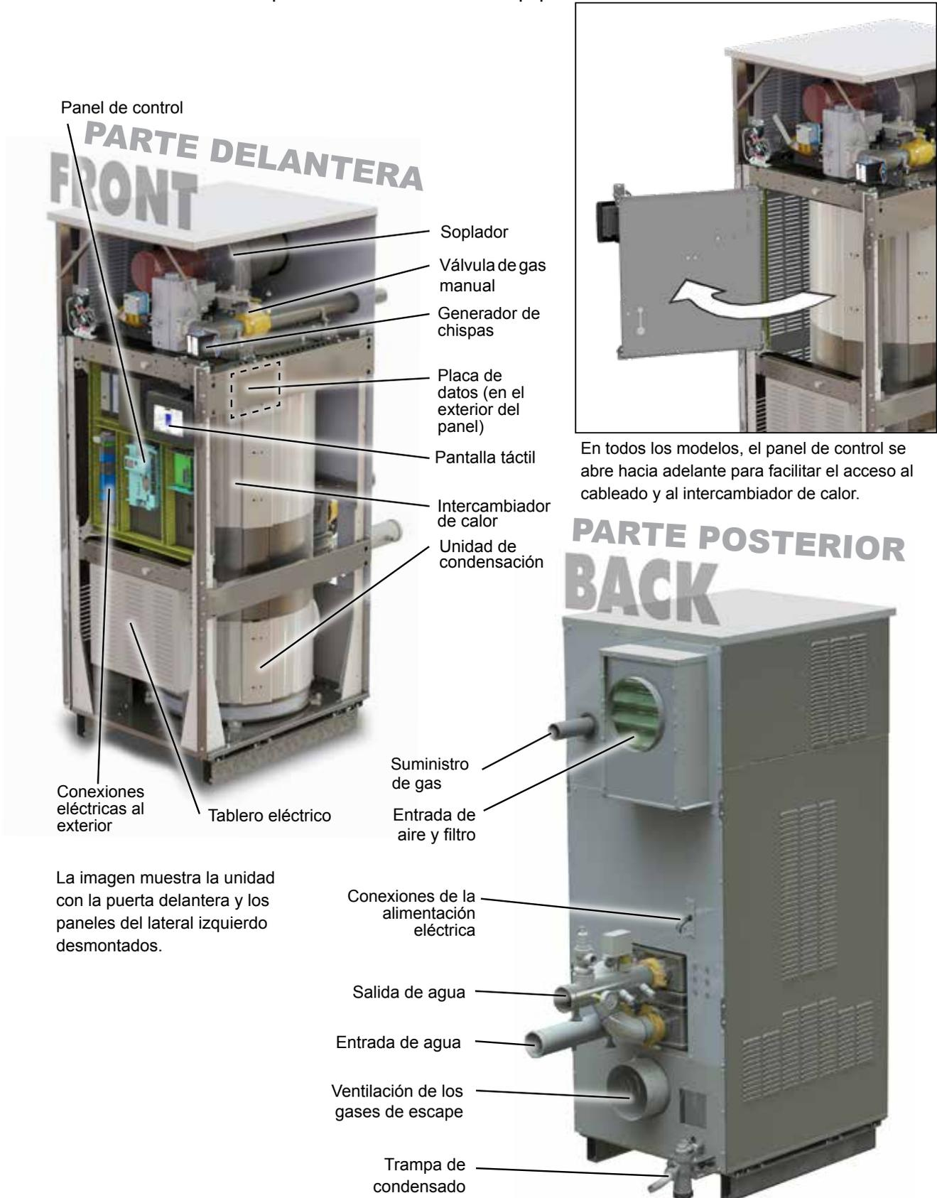
La imagen muestra la unidad con la puerta delantera y los paneles del lateral izquierdo desmontados.
