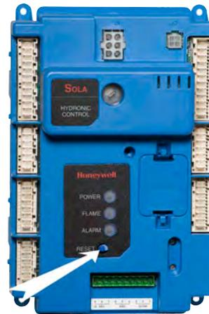
**Figure 33. Bouton de réinitialisation sur le contrôleur**
