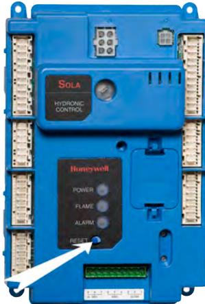
Figure 28. Bouton de réinitialisation sur le contrôleur
